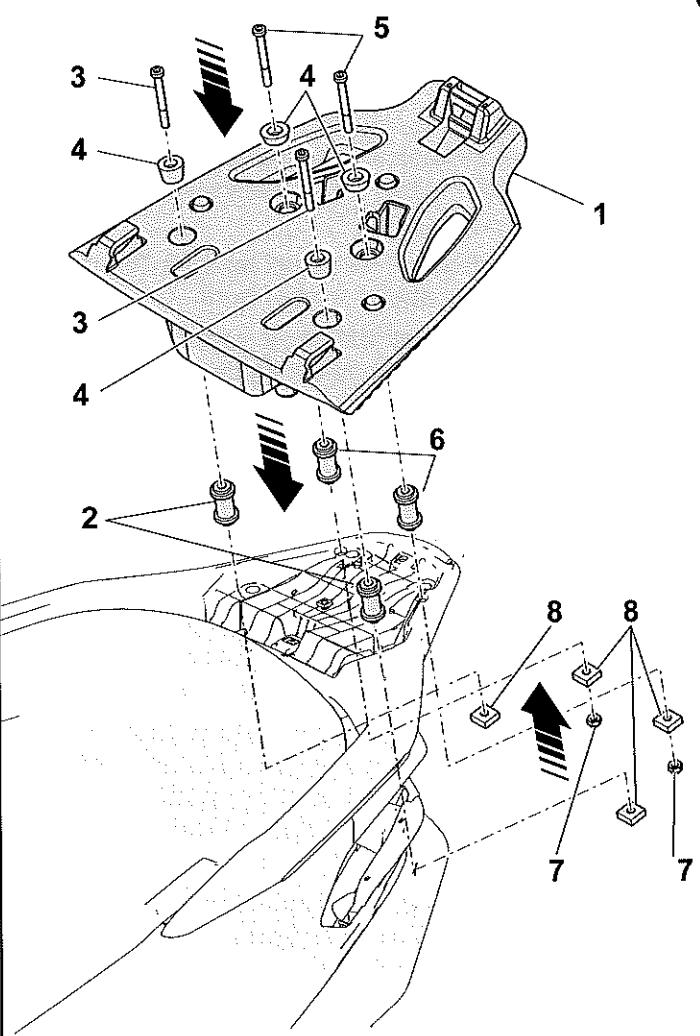
**D** Die Topcase-Platte 1 an den Bohrungen am Gepäckträger anbringen und dabei nicht vergessen, die Abstandhalter 2 und 6 wie auf der Abbildung gezeigt einzusetzen.
